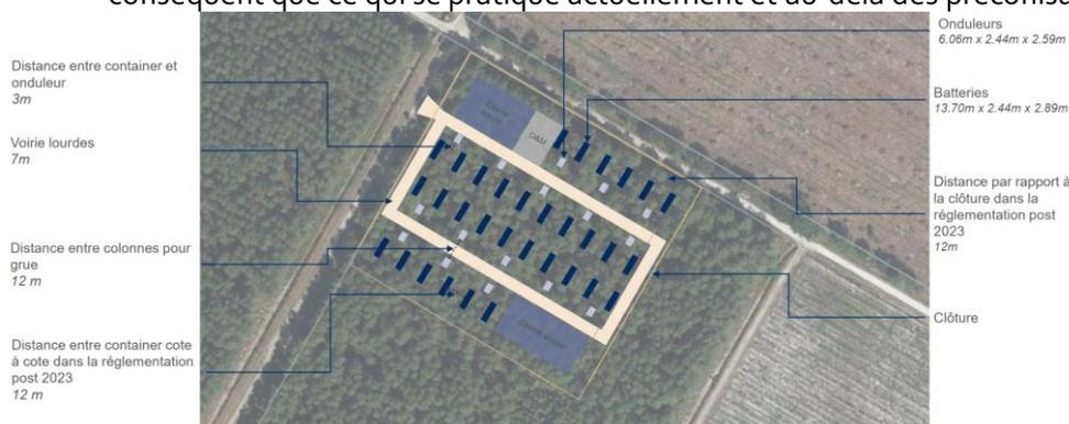
L'implantation plus précise du stockage batterie sera précisée ultérieurement et incluse dans les procédures d'obtention de permis de construire
